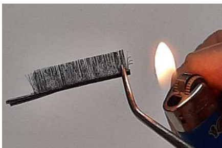
Souder l'extrémité des tronçons réunis
